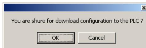
После нажатия кнопки [ОК] произойдёт запись конфигурации в контроллер. По завершении загрузки для активации необходимо перезапустить контроллер путём нажатия кнопки Reset или переподключением основного питания.
