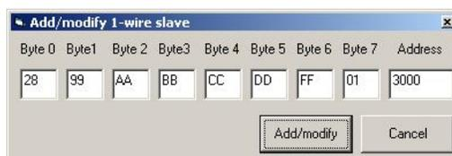
Здесь можно в ручном режиме ввести 8-байтный адрес датчика и адрес в памяти контроллера, куда будут записаны данные в случае успешного чтения температуры. Формат
